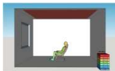
Stropní sálavé vytápění
