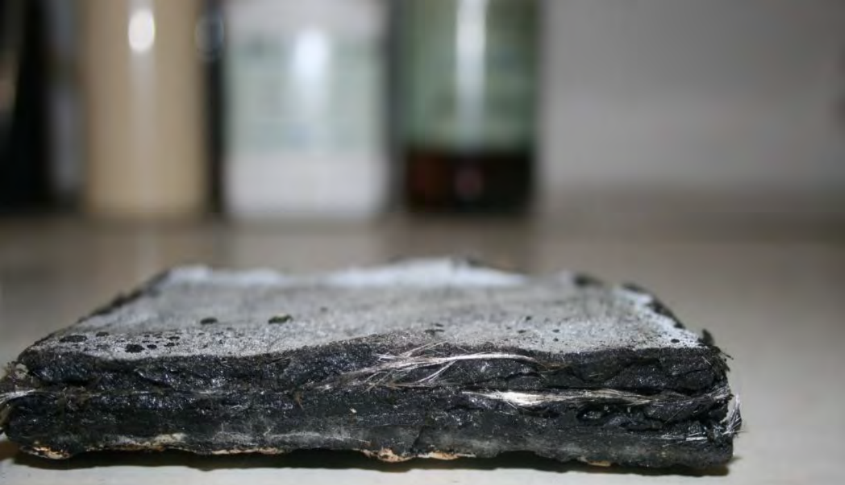
Vrstvy navařené asfaltové lepenky
