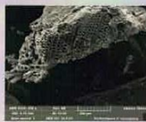
Na snímku je vidět strukturu granulovaného aktivního uhlí, které při úpravě vody na svém povrchu zachytává zbytkové organické látky a také mikropolutanty, jako jsou např. pesticidy (metoda adsorpce na aktivním uhlí).
