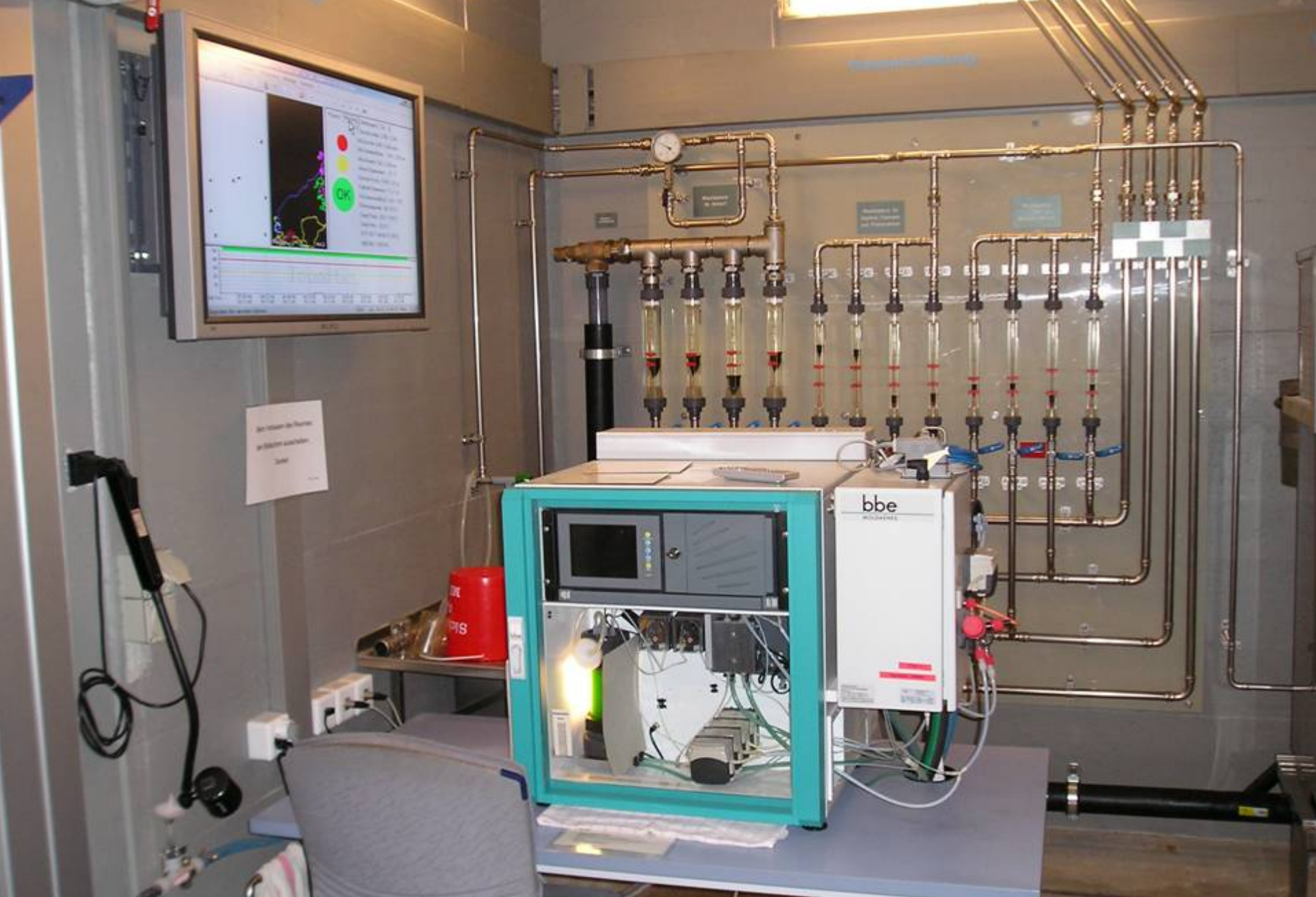
On-line biomonitoring na vodárně v curyšském Hardhofu, využívající dafnie. Dole „reaktor“ s dafniemi, vlevo nahoře na stěně obrazovka, na kterou se přenáší snímání a vyhodnocovaný pohyb dafní. Software spustí automatický alarm při překročení varovné meze.
