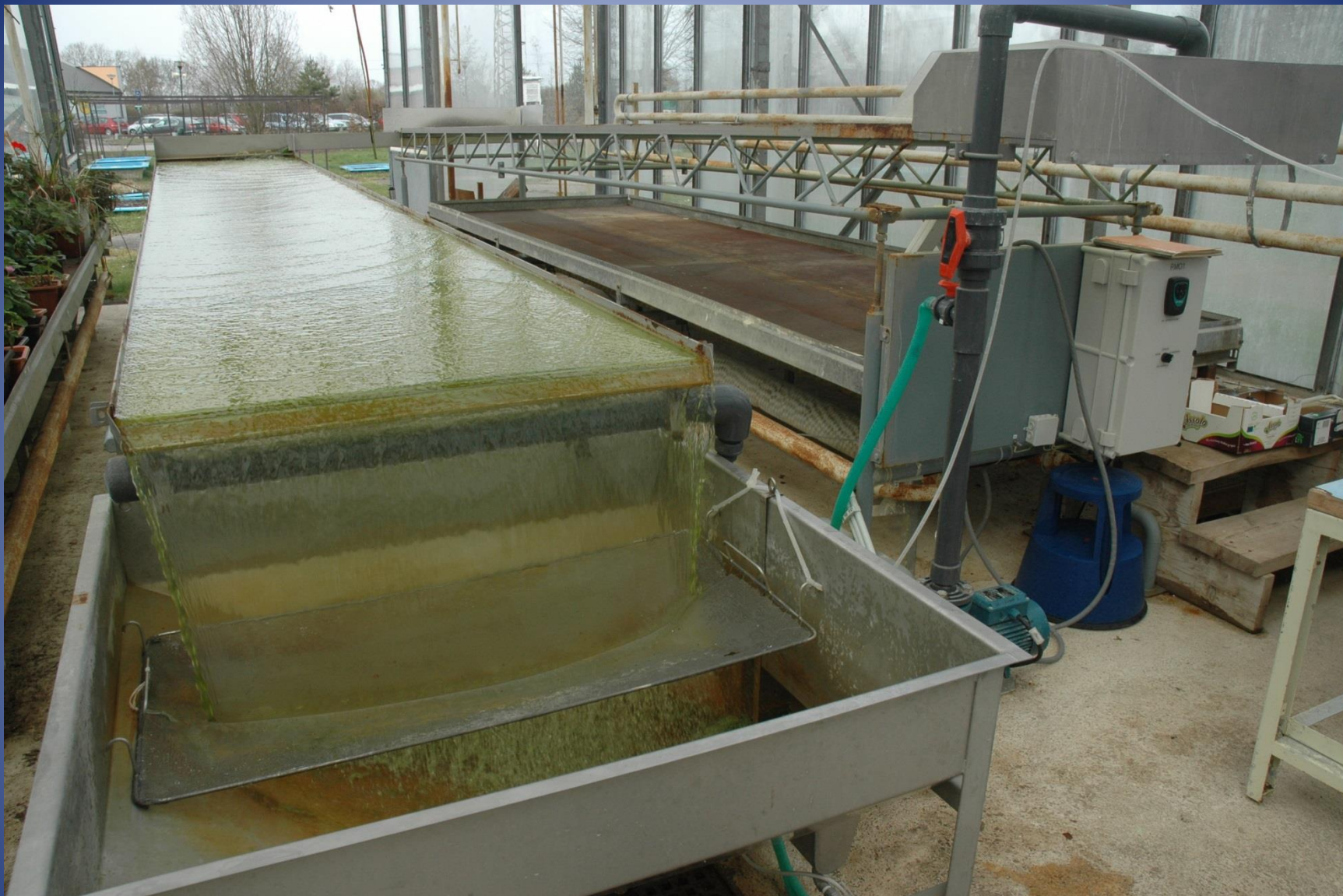
Poloprovozní kultivace řasy Bracteacoccus bullatus , tenkovrstevná plošina má plochu 12 m 2 , objem 150L.
